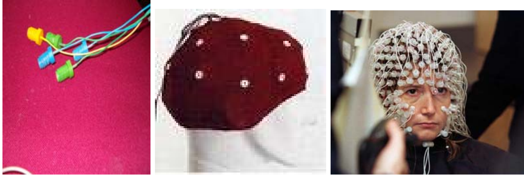
Figura 1.6: Sistemas de sujeción de electrodos EEG. A. Electrodos usados en un gorro EEG con agujeros y rosca. B. Electrocap. C. SensorNet de EGI. Tomadas de [8]
